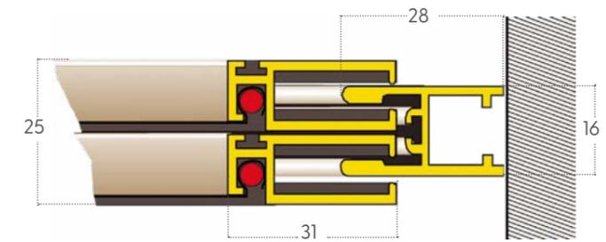
sezione orizz. con compensatore
