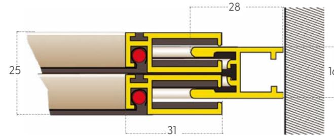
sezione orizz. con compensatore
